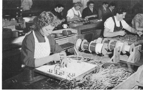
Abb. 6.2 Binden des Kabelbaumes nach Konstruktionsplan
